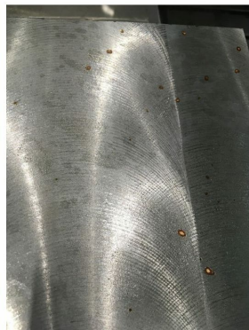
ワーク切削箇所に着して錆に変化した前油の残渣分
