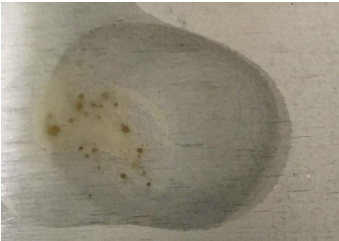
テストプレートにできたさび様の付着物
