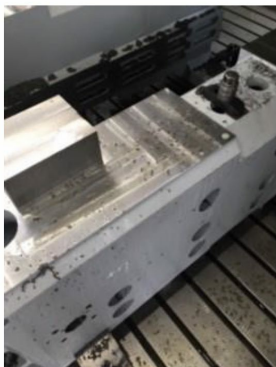
type3 使用機械でのワークに発現した錆様の付着物の様子
